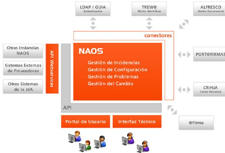
Con respecto a la arquitectura tecnológica, los dos pilares básicos son: la división de toda la aplicación en capas y el uso de interfaces. En el siguiente diagrama se recoge la arquitectura básica:
