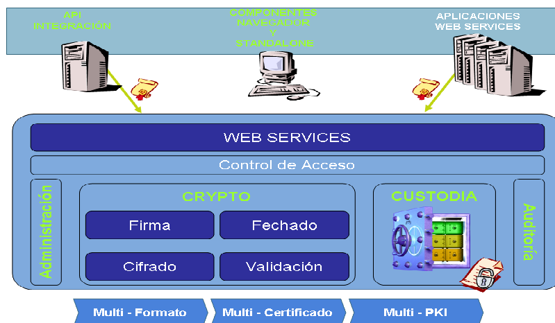
Ilustración 4. Arquitectura Lógica de los servicios de crypto y custody
