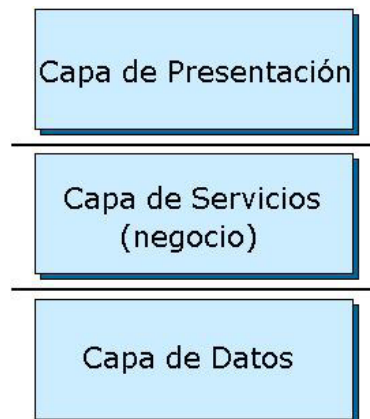
Figura 1 Diseño en tres capas
