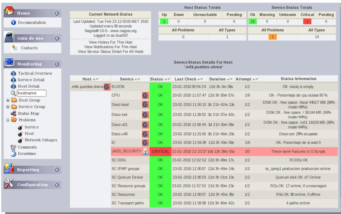
En la imagen anterior se puede observar todos los chequeos configurados para un servidor Solaris en cluster. Nagios permite visualizar rápidamente que hay un incidente y además ver el estado del resto de tests del servidor.
