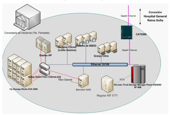
En el diagrama se observa la existencia de una librería (Magstar MP 3575), conectada mediante una conexión SCSI a servidores dentro de un sistema SP de IBM.
