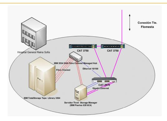
Como se aprecia en el esquema, existe una biblioteca de cintas (IBM 3584), junto con un servidor de copias dedicado (IBM PSerie 630 6C4) en el CPD2 conectado a la sala CPD1, mediante una conexión Gigabit Ethernet de 1 GB.
